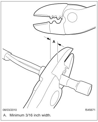
Fig. 1, Dimple-Type Crimp Tool
