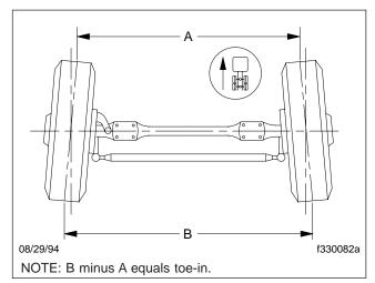
Fig. 1, Wheel Toe-In (overhead view)
