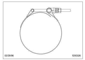
Fig. 1, T-Bolt Type Hose Clamp
