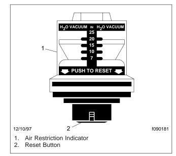
Fig. 1, Manual-Reset Air Restriction Indicator
