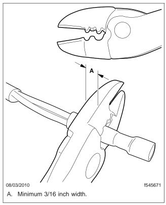
Fig. 1, Dimple-Type Crimp Tool
