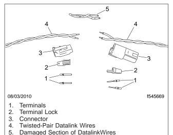
Fig. 1, Datalink Splice Parts
