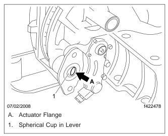
Fig. 3, Actuator Flange
