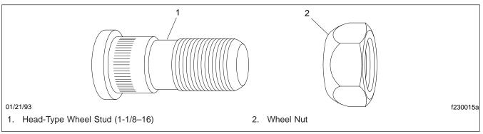
Fig. 1, Head-Type Wheel Stud
