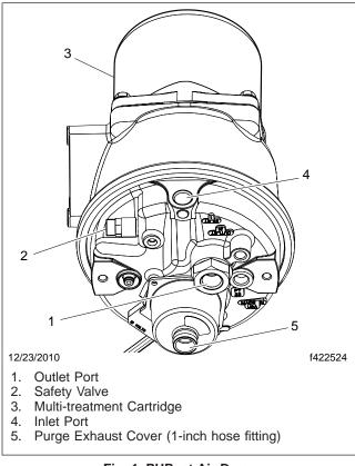
Fig. 1, PURest Air Dryer
