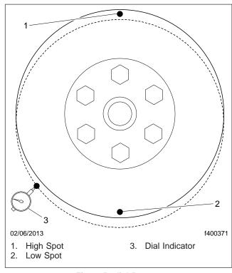
Fig. 2, Radial Runout
