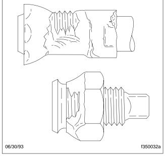
Fig. 4, Damaged Wheel Stud Nuts
