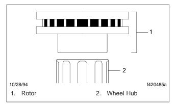
Fig. 3, Rotor-to-Hub Position
