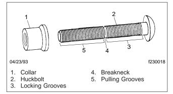
Fig. 1, Huckbolt Fastener
