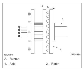
Fig. 1, Brake Rotor Runout
