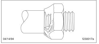
Fig. 4, Damaged Wheel Stud Nut
